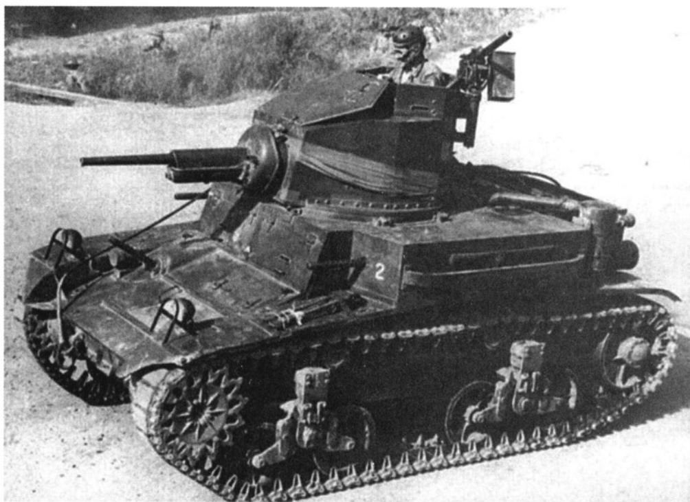
Легкий танк M2A4 из состава 2-й танковой дивизии армии США. 1941 г. Эта машина оснащена дизель- ным двигателем Guiberson T-1020.
