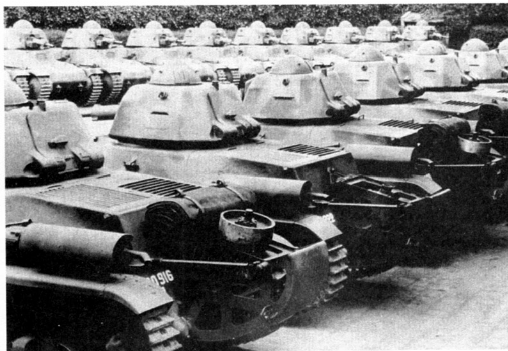
Танки Н39 на заводском дворе. Все машины оборудованы «хвостами».
