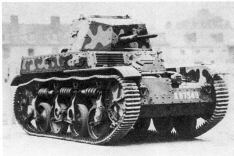
Легкий танк AMR 35ZT, вооруженный 13,2-мм пулеметом.
