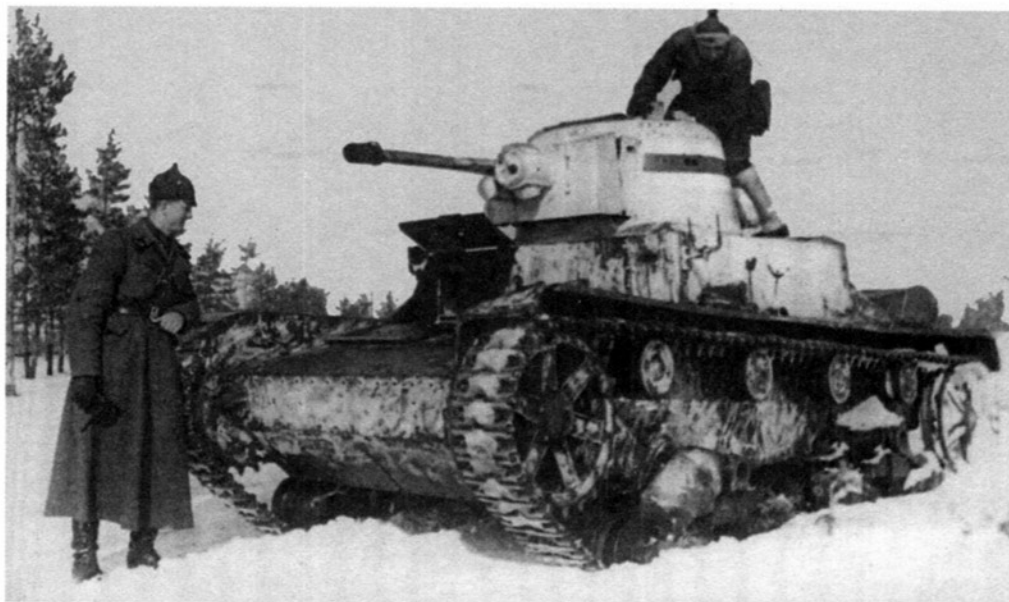
Командиры Красной Армии осматривают подбитый финский танк Vickers Mk. E mod. B, вооруженный 37-мм пушкой Bofors. Март 1940 г.
