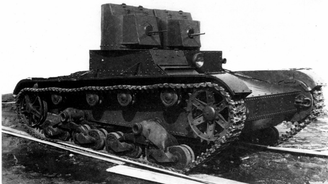
Легкий танк Т-26 обр. 1931 г. с пулеметным вооружением.
